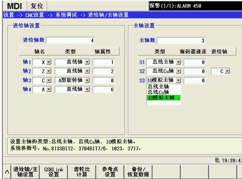
注：I/O 模拟主轴默认使用 I/O 单元 1 的模拟输出 A0T0，如果设置了 2 个 I/O 模拟主轴，则使用 I/O 单元 1 的模拟输出 A0T1，如果设置了 3 个 I/O 模拟主轴，则使用 I/O 单元 1 的模拟输出 A0T2。
