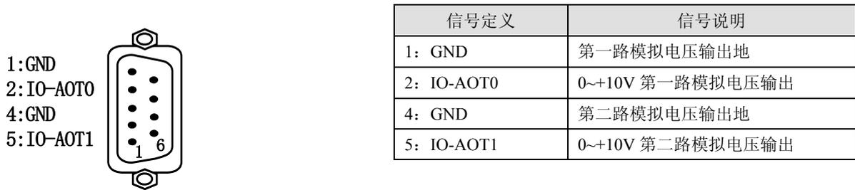
图 1-7 主轴接口管脚定义图
